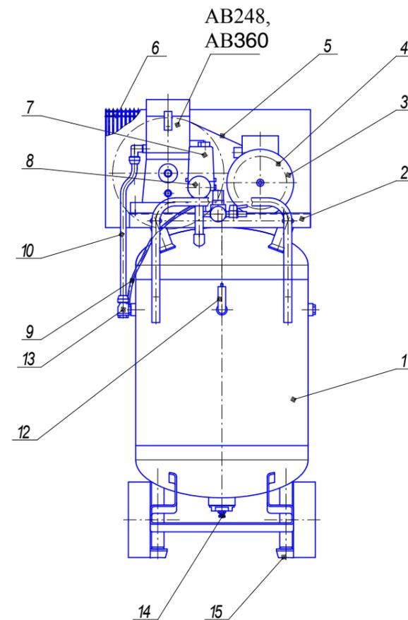
Рисунок 2 – Общий вид компрессора СБ4/С-100.АВ248АВ, СБ4/С-100.АВ360В, СБ4/С-100.АВ360АВ
