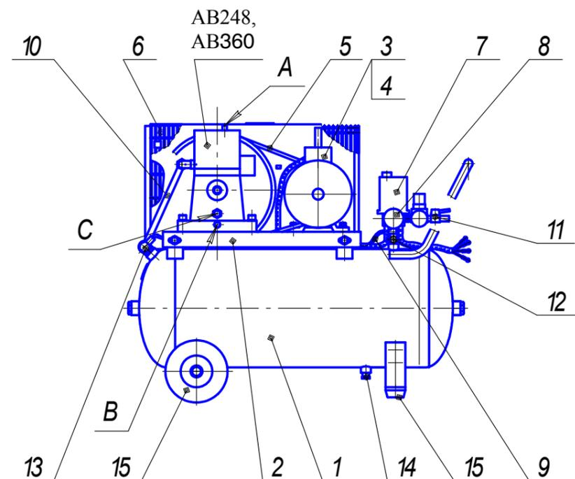
Рисунок 1 – Общий вид компрессора СБ4/С-50.АВ248А, СБ4/С-100.АВ248А СБ4/С-50.АВ360, СБ4/С-50.АВ360А, СБ4/С-100.АВ360, СБ4/С-100.АВ360А
