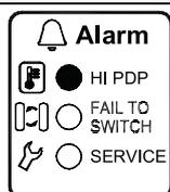
Высокая точка росы: Мигание этого индикатора означает, что точка росы (DewPoint) слишком высокая. Использование этой функции возможно лишь в том случае, если установлен датчик Точки росы - опция - и если ПЕРЕКЛЮЧАТЕЛЬ DIP (см. специальный раздел) установлен в соответствующее положение.
