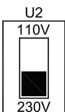
Если выключатель находится в нижней позиции, DDC15 должен быть подключен к сети с напряжением **220-240 V**.
