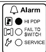
Высокая точка росы: Мигание этого индикатора означает, что точка росы (DewPoint) слишком высокая. Использование этой функции возможно лишь в том случае, если установлен датчик Точки росы - опция - и если ПЕРЕКЛЮЧАТЕЛЬ DIP (см. специальный раздел) установлен в соответствующее положение.
