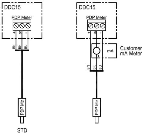
При стандартных установках аналоговый сигнал, подаваемый преобразователем Точки Росы, подается только на контроллер DDC15. Пользователь может использовать получаемый аналоговый сигнал 4-20mA для других целей (мониторинг показателя влажности и т.д.).
