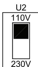
Если выключатель находится в верхней позиции, DDC15 должен быть подключен к сети с напряжением **110-120 V**.
