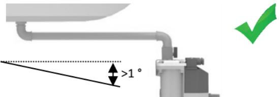
В случае, если наклон подающей трубы недостаточен, а также в случае наличия других проблем с потоком среды необходимо установить вентиляционную линию, которая позволит предотвратить образование воздушного замка.
