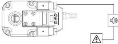
4. Для создания замкнутого контура подключите источник питания к вилке аварийной сигнализации. Верните вилку на место и затяните винт вилки(максимальный крутящий момент – 0,3 Нм). Убедитесь, что уплотнение надежно зафиксировано и обеспечивает класс защиты IP65.
