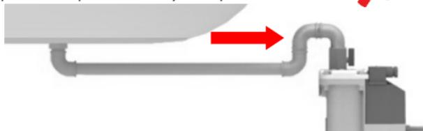
Подающая труба должна быть горизонтальной или (предпочтительнее) иметь наклон вниз ( $>1^\circ$ ).
