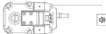
3. Подключите устройство сигнализации к источнику питания. Тип аварийного выключателя: выключатель с релейным выходом. Внешний источник питания необходим вследствие того, что точка подключения аварийной сигнализации к конденсатоотводчику работает только в качестве выключателя-реле.
