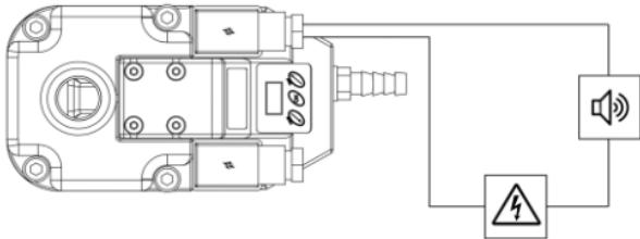
1. Отвинтите винт вилки, снимите крышку с вилки аварийной сигнализации и подключите кабели сигнализации к вилке так, как указано ниже. При этом необходимо соблюдать особую осторожность, так как в этом случае вы можете работать с опасным напряжением!
