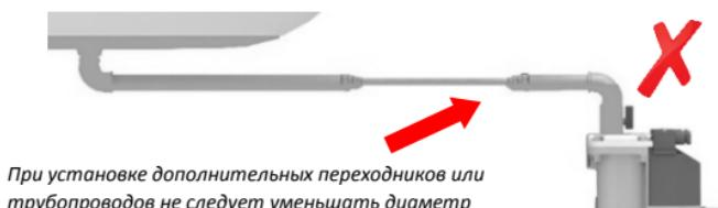
При установке дополнительных переходников или трубопроводов не следует уменьшать диаметр подающего трубопровода, т.к. это может привести к образованию воздушных пробок.
