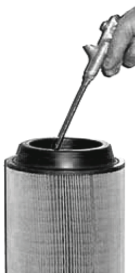
Рис. 6.3 Очистка фильтрующего элемента воздушного фильтра
