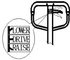
Рисунок 3. LOWER: опускание – положение опускания; DRIVE: движение – среднее положение; RAISE: подъем – положение подъема.
