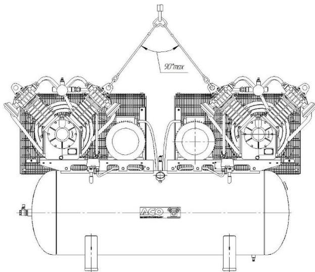
**Рис.25** Схема строповки установки компрессорной
