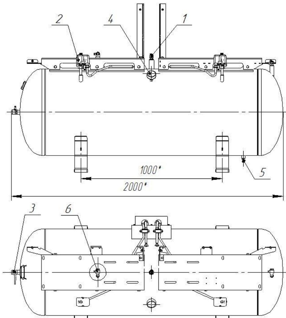
**Рис.12** Ресивер установки компрессорной
