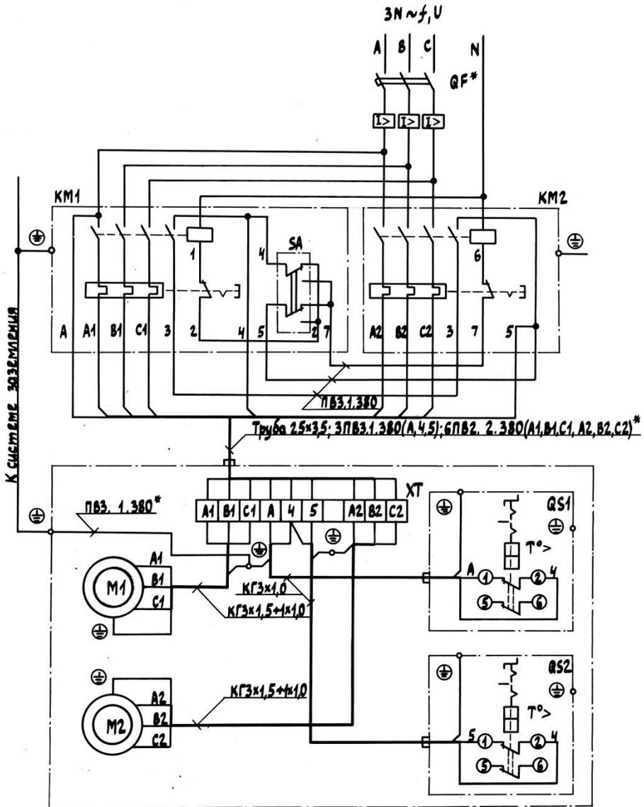
Рис.20 Схема электрическая принципиальная и соединений установки компрессорной, модель К20М
