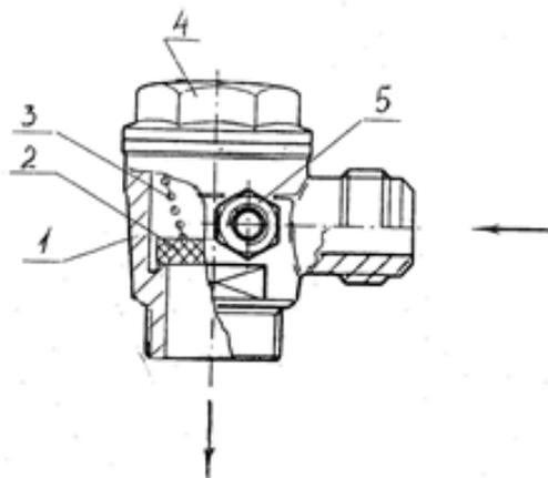
**Рис 15 Обратный клапан**
