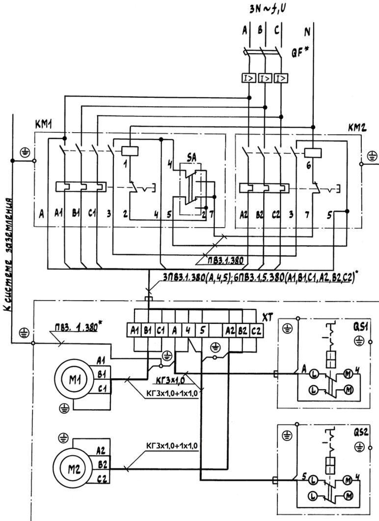
Рис.21 Схема электрическая принципиальная и соединений установки компрессорной, модель К30, К30-01
