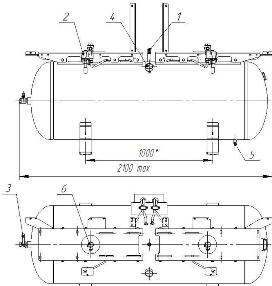
**Рис.10 Ресивер установки компрессорной,
