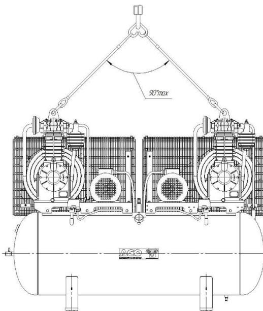
**Рис.26** Схема строповки установки компрессорной
