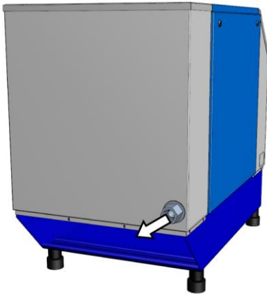
Рис. 20: Подключение сжатого воздуха
