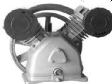
Узел насоса LB50-2 (новый)
