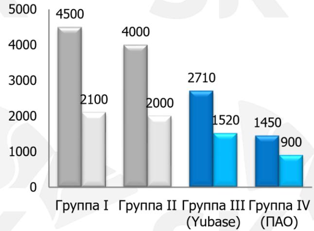
CCS – имитатор холодного пуска температурах MRV – прокачиваемость при отрицательных температурах
