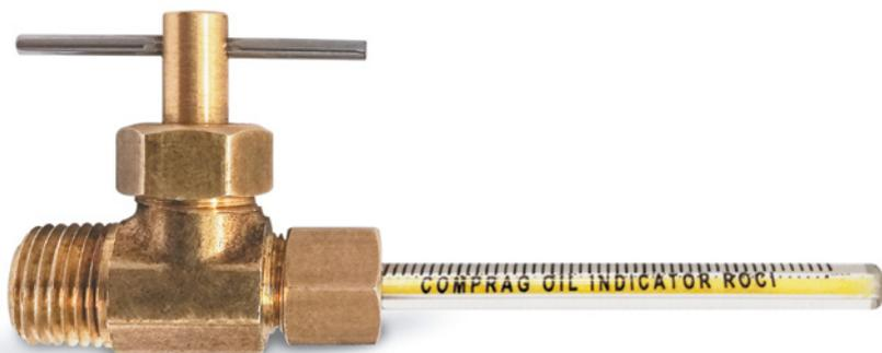
Индикатор ROCI предназначен для индикативного контроля общего остаточного содержания масел в сжатом воздухе. Любое масло в жидкой или аэрозольной фазе, присутствующее в сжатом воздухе, вызывает пропорциональную цветовую индикацию в трубке индикатора.
