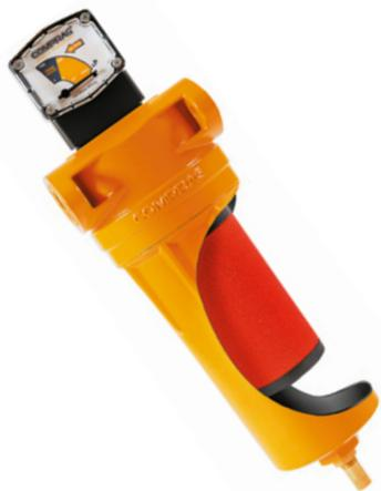
Комплектный фильтр DFF-....-S: Коалесцентный Суперфилтрация по частицам и аэрозолям. Фильтровальный материал на основе стекловолокна, рифлённый, наружный дренажный слой.
