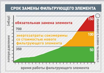
Для градации P, M и S: - При падении давления увеличение энергозатрат соизмеримо со стоимостью нового фильтрующего элемента. При падении давления на 350 мбар (максимум) – замена фильтрующего элемента обязательна.
